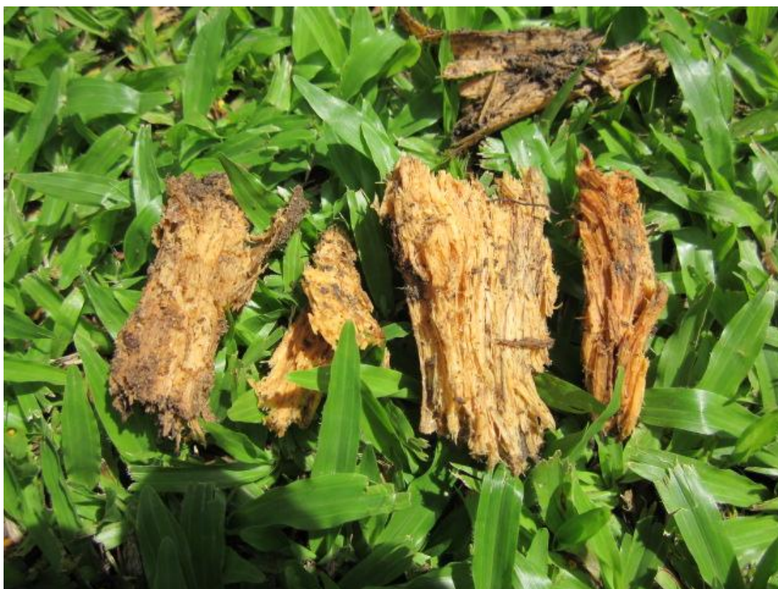
ภาพที่ 2 ลักษณะของเนื้อไม้ที่ผุเน่า มีลักษณะชุ่มน้ำ และเนื้อไม้หลุดออกได้ง่าย
